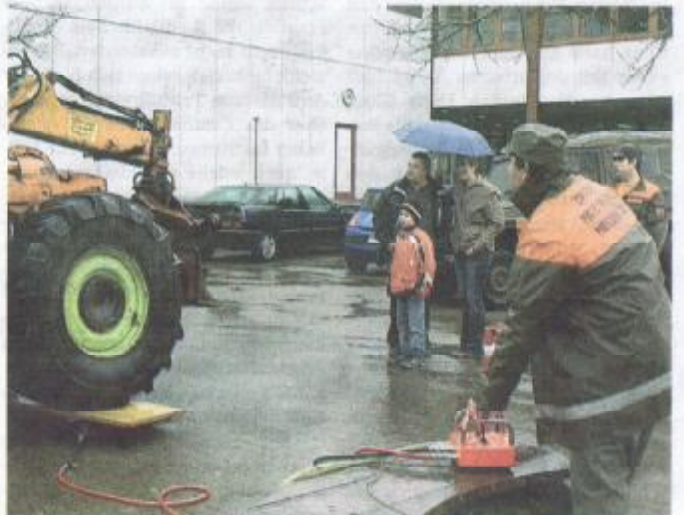
Die Zivilschutzorganisation gibt einen Einblick in ihre Tätigkeit: Mit einem Kissen wird der Traktor angehoben.
